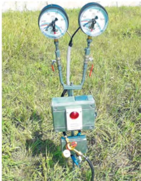
Прибор для наблюдения за давлением во временных герметизирующих устройствах
